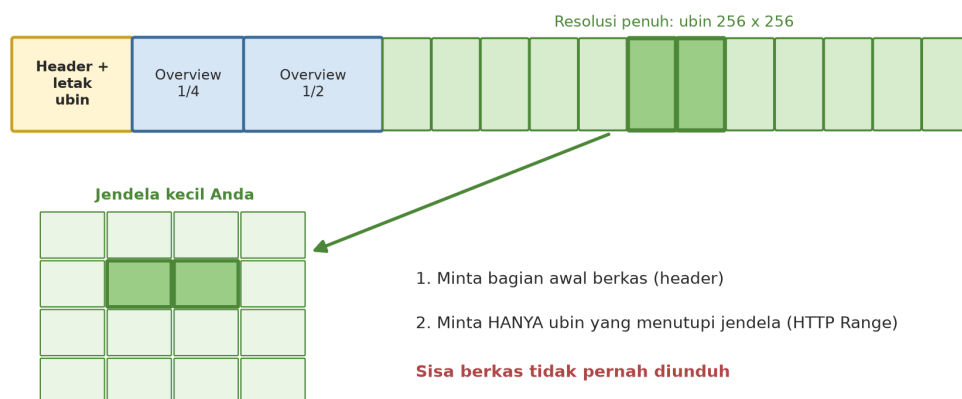
Gambar 0.1: Isi berkas COG: header dulu, lalu overview, lalu ubin. Untuk satu jendela kecil, hanya header dan ubin yang menutupinya yang diminta.
