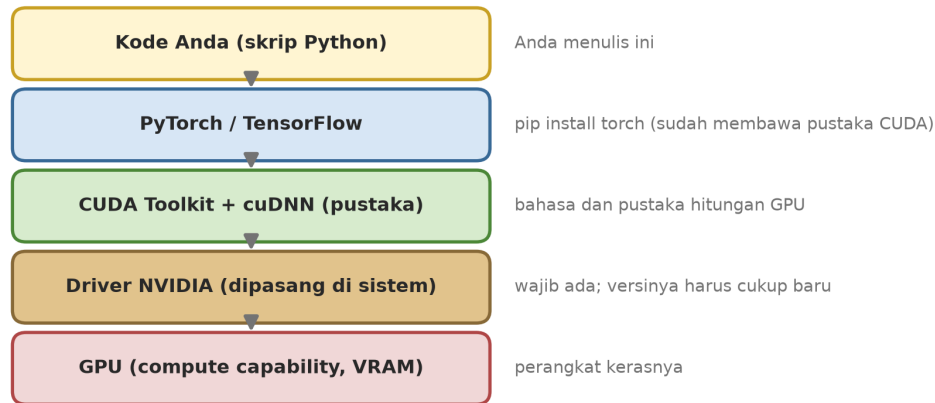
Gambar 0.2: Tumpukan perangkat lunak AI di GPU NVIDIA. Yang wajib Anda pasang sendiri hanya driver.
