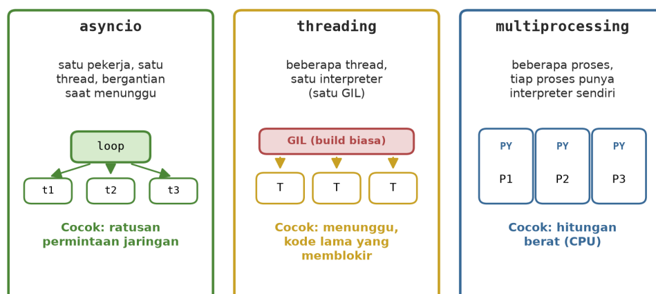
Gambar 0.1: Tiga cara mengerjakan banyak hal sekaligus: asyncio, threading, multiprocessing.
